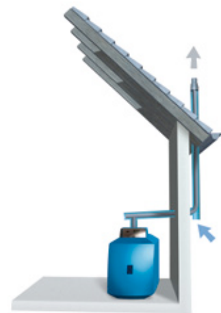
Raumluftunabhängige Aufstellvariante mit Rohr-in-Rohr-Kunststoff-Abgassystem entlang der Außenfassade
