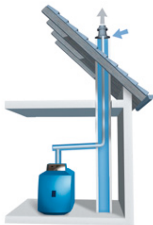
Raumluftunabhängige Aufstellvariante mit eingezogener Kunststoff-Abgasleitung im Schornstein
