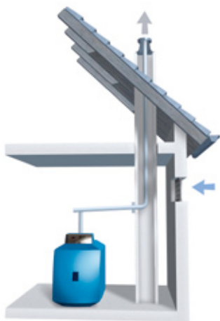
Raumluftabhängige Aufstellvariante mit eingezogenem Abgasrohr im Schornstein
